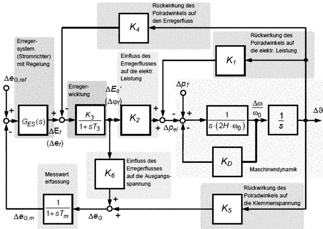
**Bild 1.14** Heffron-Phillips-Modell eines Synchrongenerators mit Erregersystem
